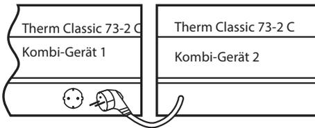
Die zu koppelnden Geräte werden nebeneinander aufgehängt oder gestellt, wobei das Verbindungskabel des einen Gerätes, je nach bestellter Konfiguration in eine zweite Wandsteckdose oder in die rückwärtige Steckdose des Hauptgerätes gesteckt wird.
